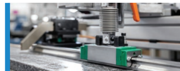
Rezanje linearnih vodil in sestavljanje z vozički po specifikacijah.
