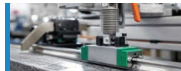
Rezanje linearnih vodilica i montaža prema specifikacijama.
