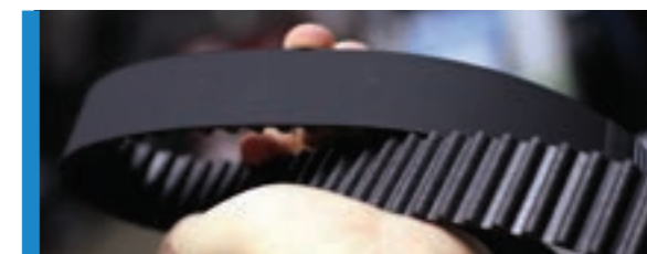
Izrada zupčastih remena od čahura prema željama korisnika.
