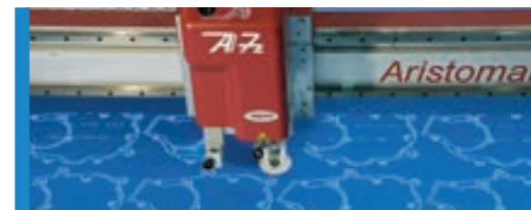
Proizvodnja ravnih brtvi od različitih materijala.
